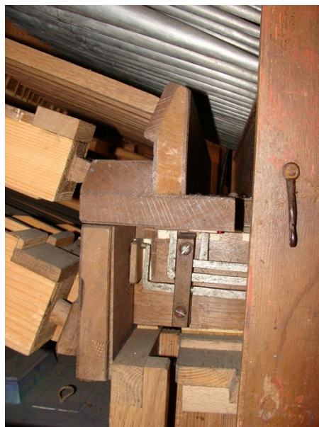
Afb.7) Zijaanzicht van de windlade: pijpstokken, slepen en registermechaniek
