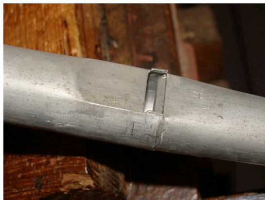
Afb.9) Detail van een pijp met 'Stummelbärte'
