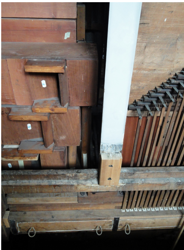
Links op de foto enkele liggende Subbass-pijpen (met de voet aan de zijkant van de pijp), rechts het wellenbord van het manuaal.
