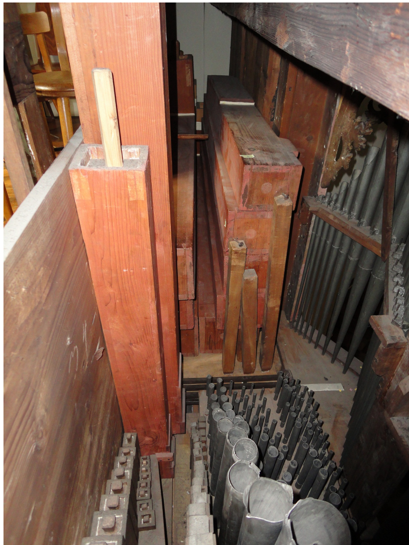
Foto van het binnenwerk: geheel links de achterkant van het wellenbord, rechts is de achterkant van enkele frontpijpen herkenbaar. De pijpen van de Subbass worden met houten kokertjes van wind voorzien. Achter het metalen binnenpijpwerk zijn de ijzeren registerwalsen zichtbaar.
