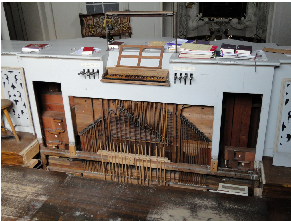
Claviatuur en geopende orgelkast van het orgel. Een deel van de vloer is verwijderd zodat de windlade zichtbaar is. Ter weerszijden van het wellenbord zijn de pijpen van de Subbass horizontaal gepositioneerd.
