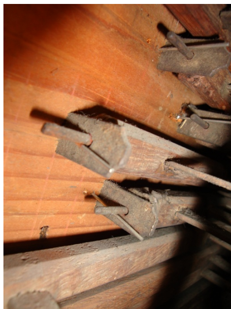
Detail van het wellenbord met ijzeren nokken en veertjes op de stiften/assen.
